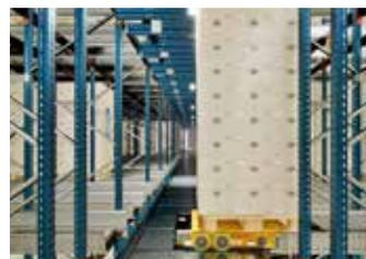
**3.** Une fois devant le canal de stockage, la navette soulève légèrement la palette et y pénètre pour la déposer à l'emplacement libre le plus éloigné.
