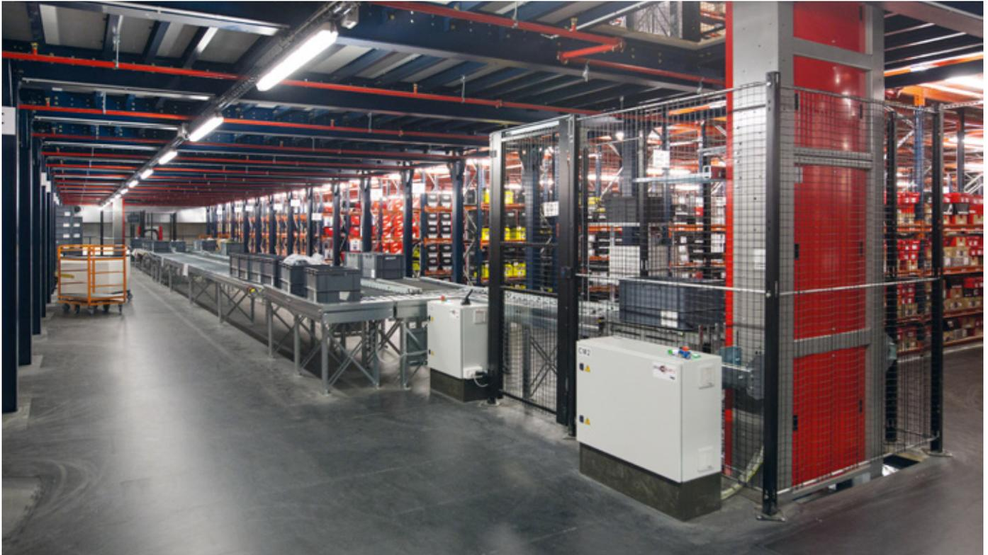
L'élévateur vertical déplace automatiquement les caisses jusqu'au niveau correspondant
