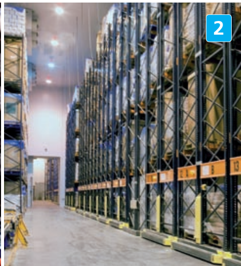
Les commandes à rotation moyenne sont stockées dans les rayonnages montés sur des bases mobiles ou sur des palettes de dimensions variées.
