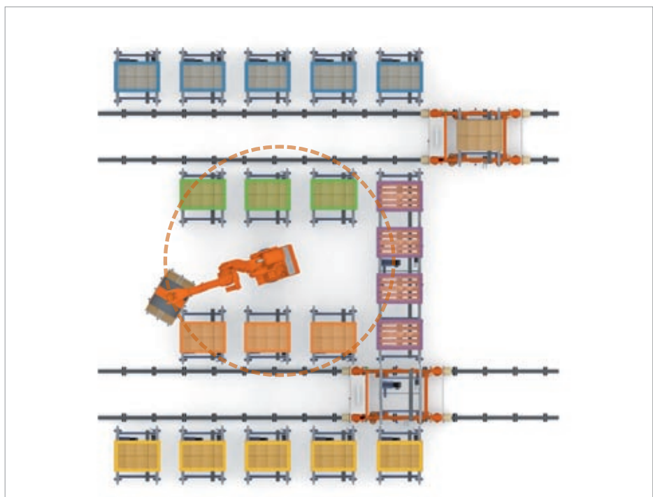
Schéma de fonctionnement du système de picking automatique par robot dépalettiseur.
