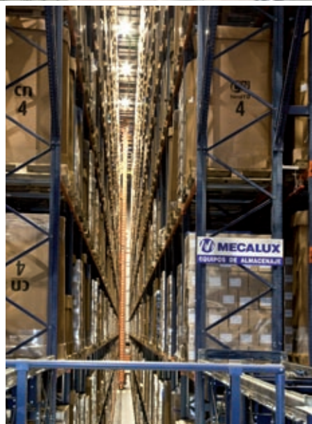
Allée de stockage équipée d'un transstockeur.
